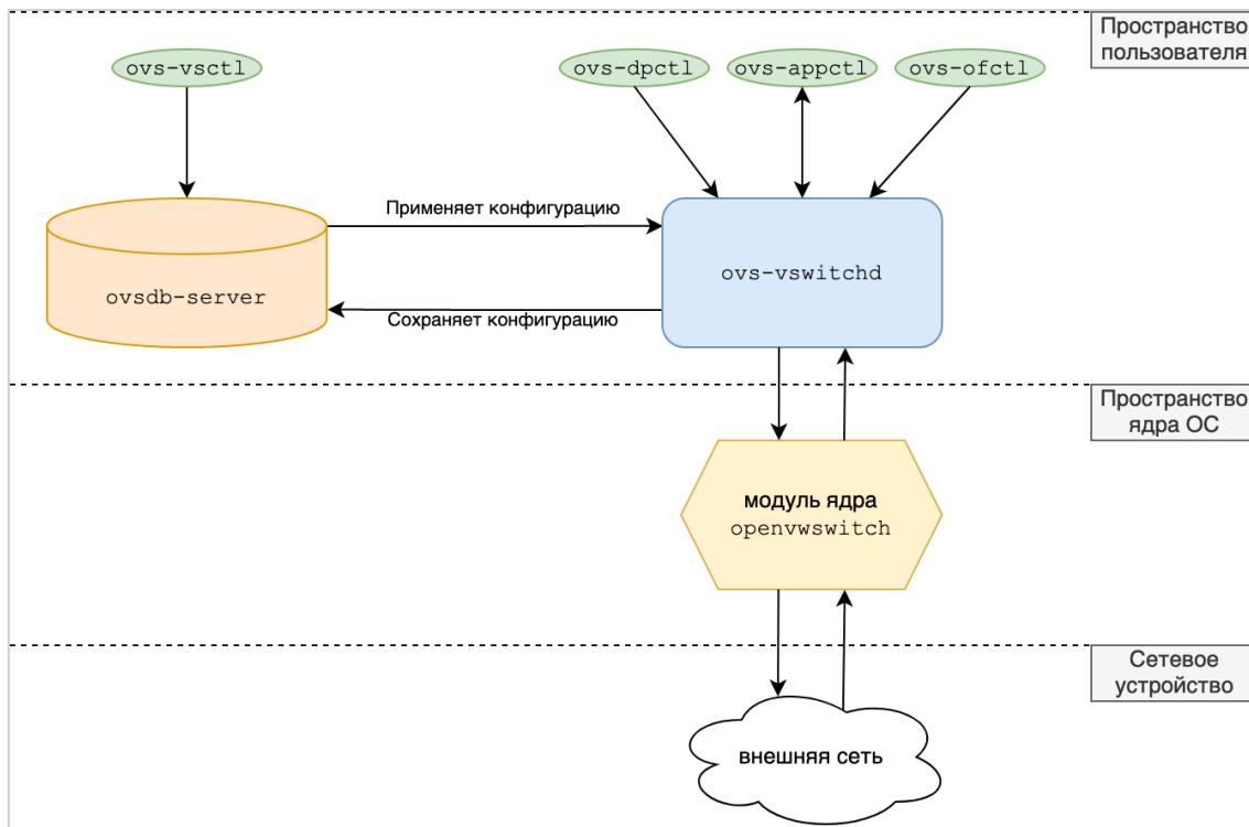
Сетевые устройства в концепции Open vSwitch, делятся на пять типов:
