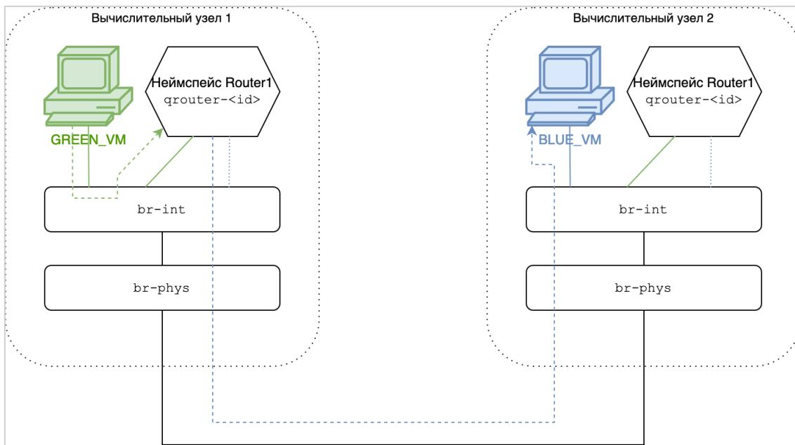
Итак, две подсети соединены одним маршрутизатором Router1, имеющим по одному интерфейсу Router1 interface 0 и Router1 interface 1 в каждой из этих подсетей.
