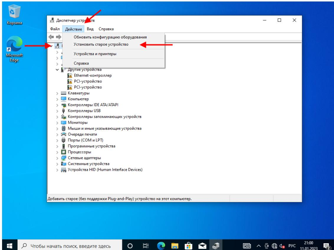
После запуска **Мастера установки оборудования** нажать **Далее → Установка оборудования, выбранного из списка вручную → Далее**.
