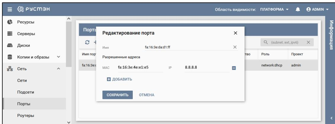
Максимальное количество доступных пар адресов регулируется опцией `max_allowed_address_pair` в конфигурационном файле `/etc/neutron/neutron.conf` узлов с ролью «Управление сетями». Если оно не определено, то в «Разрешённые адреса» можно указать до 10 пар IP/MAC-адресов для одного порта.
