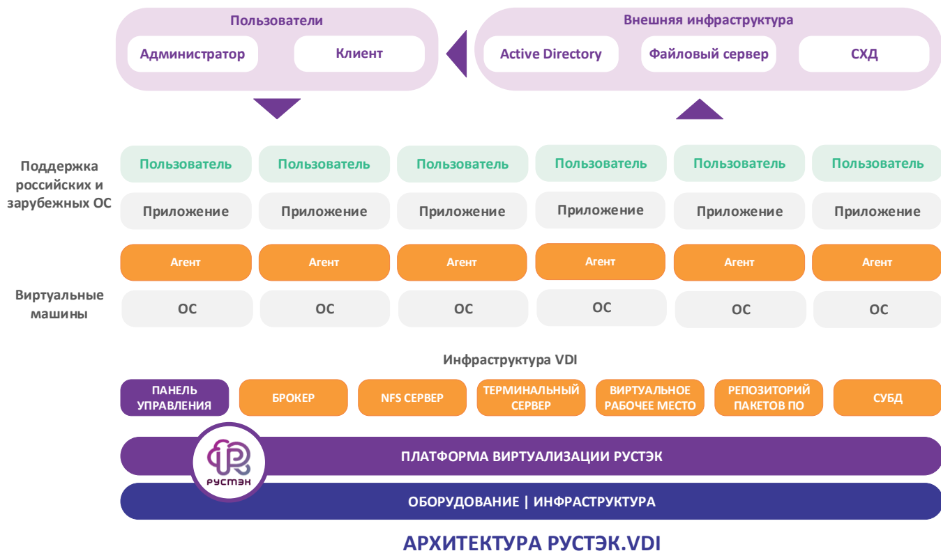
Рисунок 1 – Архитектура программного комплекса
